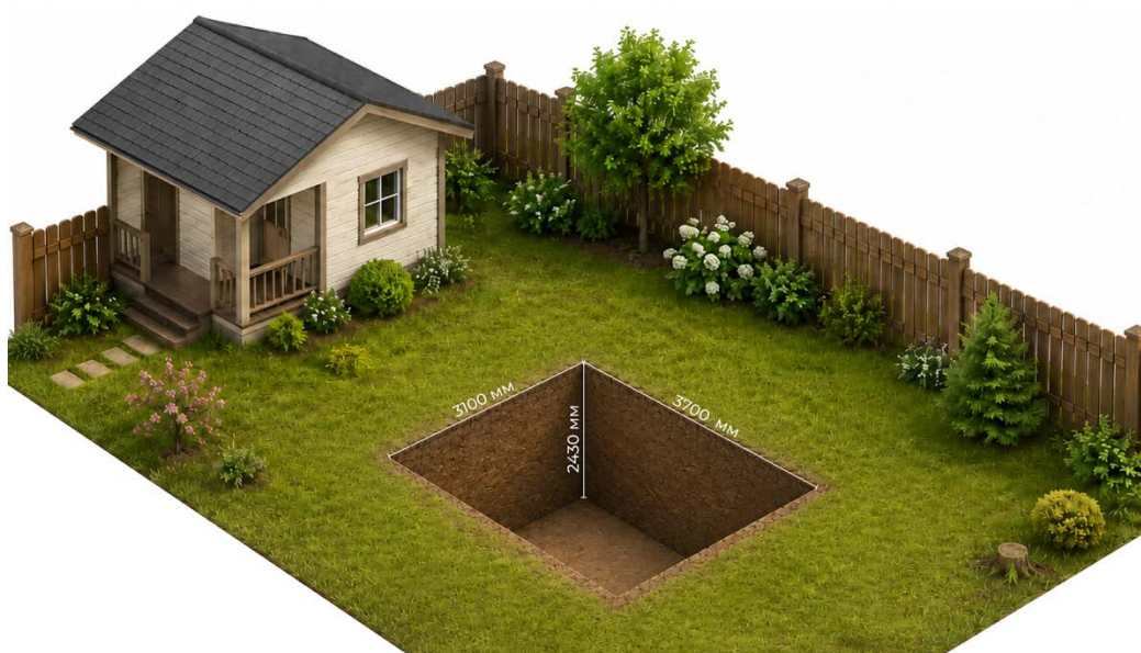
Рисунок 1 – Размеры котлована под погреба с монтажной юбкой
